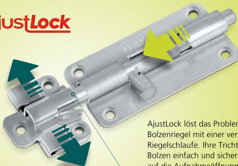
AjustLock löst das Problem herkömmlicher Bolzenriegel mit einer vertikal verschiebbaren Riegelschleufe. Ihre Trichterform nimmt den Bolzen einfach und sicher auf, ohne dass er exakt auf die Aufnahmeöffnung ausgerichtet sein muss.
